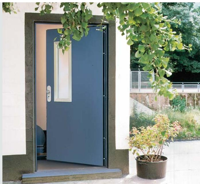
Le bloc-porte de sécurité E55-1 de Hörmann : avec huisserie d'angle, il s'avère classé 3 anti-effraction, selon norme ENV 1627. Ce bloc-porte est équipé d'une serrure 5 points, d'un béquillage de sécurité classe ES2 ton aluminium à bouton extérieur, ainsi que d'un vitrage 140 x 185 mm avec verre feuilleté 18 mm et pareclose en aluminium anodisé. Il est proposé à partir de 3.297 € HT, hors pose et hors laquage par utilisateur final.
